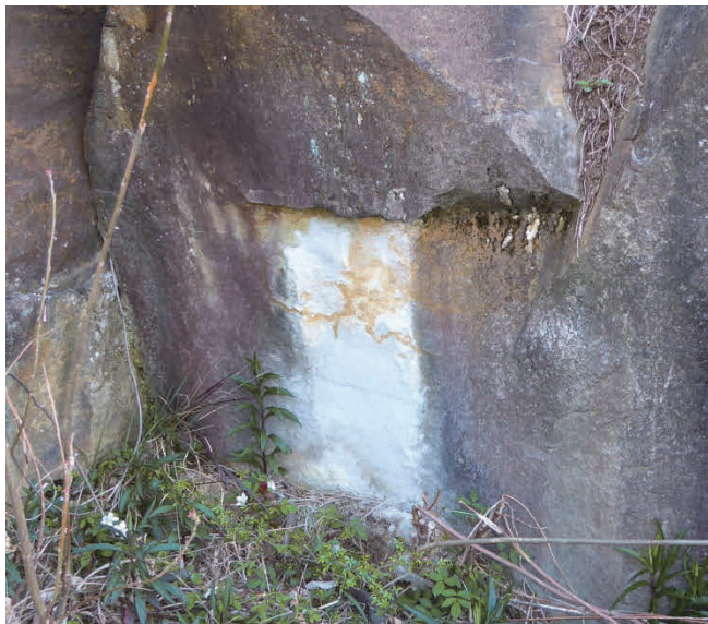
図－5 石切場における塩類風化
