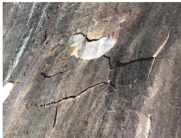
図－4 下浦石石切場で見られる板状剥離
