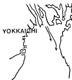
第12図 模型実験の結果の流線の模式図 (潮汐なし, コリオリ力なし, 海底地形なし, 河川水 (密度差なし) 流入の 0.5 cc/sec 時)
