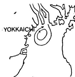
第13図 模型実験の結果の流線の模式図 (潮汐なし, コリオリ力あり, 海底地形なし, 河川水 (密度差なし) 流入 0.5 cc/sec の時)
