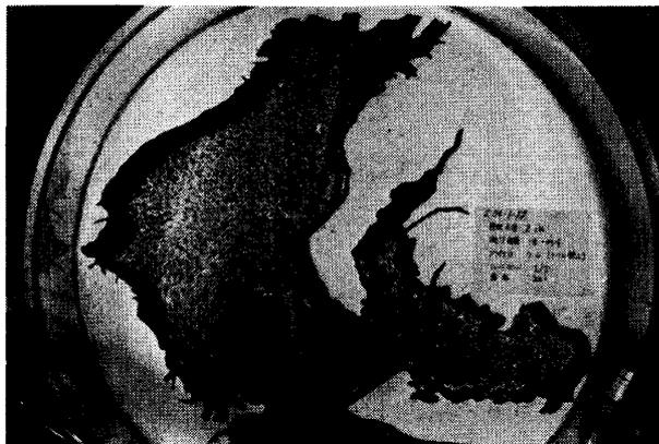
第 4 図 模型実験結果の写真画像 (潮汐周期 14 秒, コリオリ力なし, 海底地形なし, 河川水流入なしの時)
