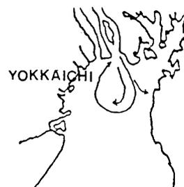
第14図 模型実験の結果の流線の模式図 (潮汐なし, コリオリ力なし, 海底地形なし, 河川水 (密度差あり) 流入 0.5 cc/sec の時)
