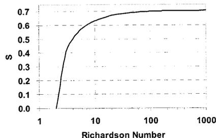
図 1 理論式(5)で計算されるパラメータ  $S$  (鉛直速度) の Richardson 数 (鉛直シア) 依存性。
