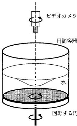
図1: 実験装置の概要
