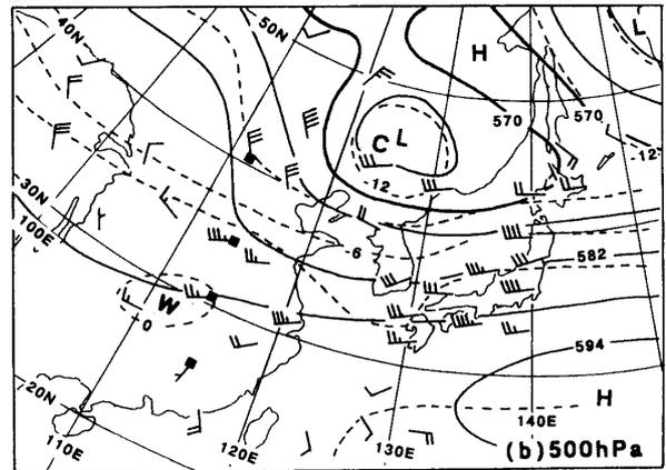
第3図 1983年7月21日12 UTCの高層天気図. 実線は等高線 (60 mごと, 単位10 m), 破線は等温線 (3°Cごと). 短矢羽根は5ノット, 長矢羽根は10ノット, ペナントは50ノット (1ノット=0.51 m/s). (a) 850 hPa面, (b) 500 hPa面.
