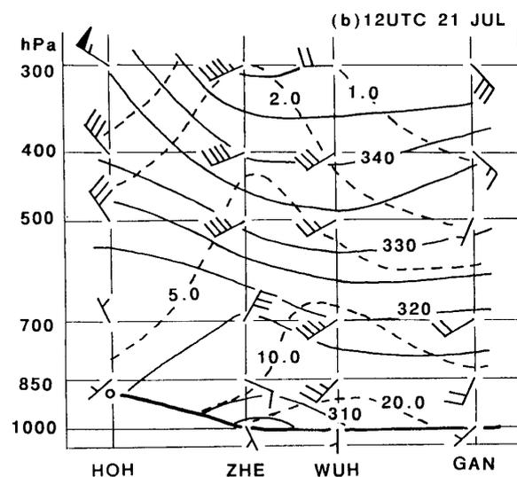
第7図 第1図の太破線に沿った鉛直断面図. 実線は  $\theta_e$  (K), 破線は混合比(g/kg). (a) 00 UTC, (b) 12 UTC.
