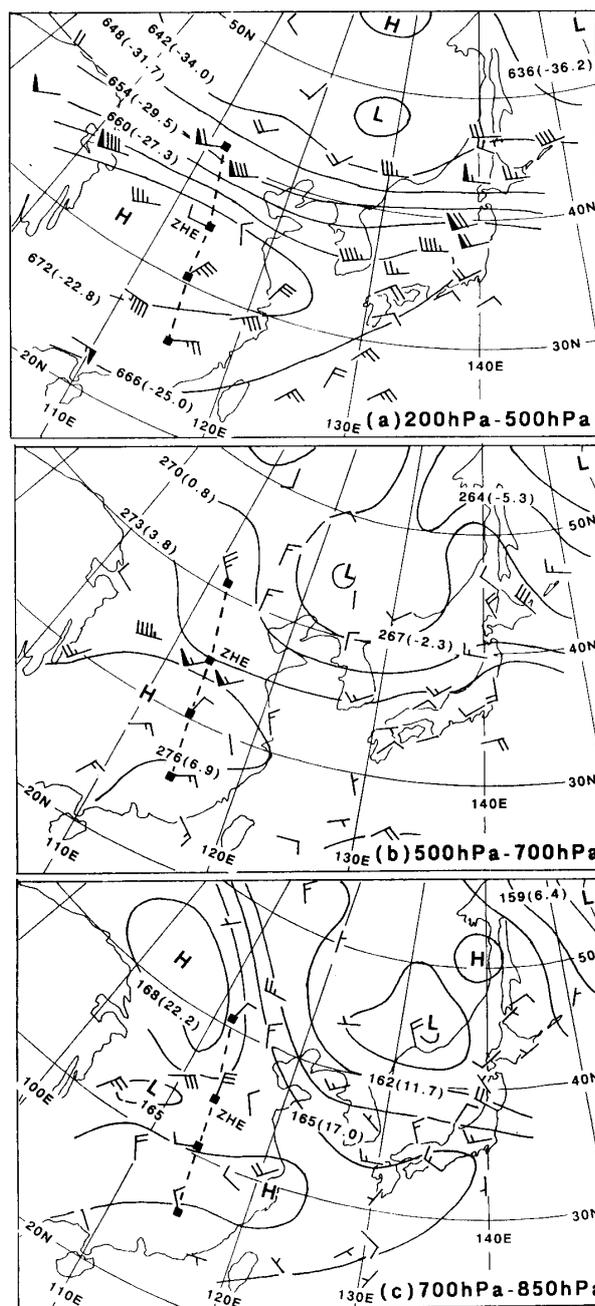
第6図 1983年7月21日12 UTCの層厚の分布（単位10 m）。カッコ内は気層の平均仮温度を°Cで表したもの。矢羽根は鉛直シアベクトルで，大きさは第3図の風速と同じ。(a) 200 hPa～500 hPa の層厚（60 m ごと）。(b) 500 hPa～700 hPa の層厚（30 m ごと）。(c) 700 hPa～850 hPa の層厚（15 m ごと）。
