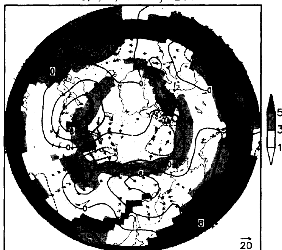
第8図 2003年7月の300 hPa 流線関数偏差 (等値線), 波活動度フラックスの水平成分 (矢印), K_s (陰). 流線関数偏差の等値線間隔は 4 \times 10^6 \text{ m}^2/\text{s} , 波活動度フラックスのスケールは図右下のとおりで単位は \text{m}^2/\text{s}^2 .
