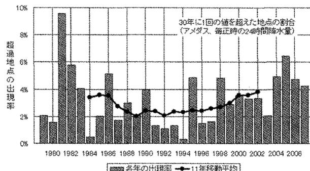
第7図 年最大24時間降水量が再現期間30年の確率降水量を超えたアメダス地点の出現率。棒グラフ：各年の出現率、折れ線：11年移動平均値。
