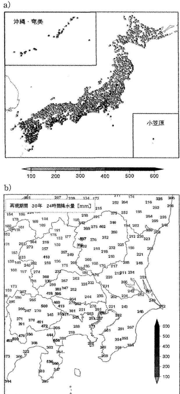
第 4 図 アメダス地点における 1976～2007 年の年最大 24 時間降水量から推定した再現期間 30 年の確率降水量。a：全国図，b：関東地方拡大図。
