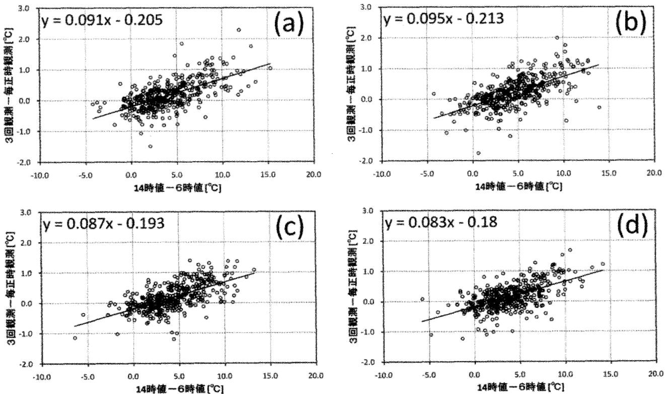
第4図 [14時値-06時値の気温] (横軸) と [3回観測による日平均気温-毎時値による日平均気温] (縦軸) の関係。図中の式は回帰直線を示す。(a) 2006年, (b) 2007年, (c) 2008年, (d) 2009年。
