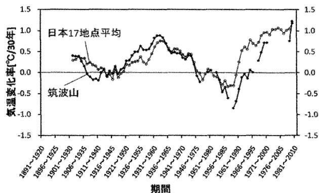
第7図 筑波山頂（太線）と日本17地点（細線）の30年の気温変化率の変動。筑波山頂には観測回数による補正を施している。期間は1902年から2009年。
