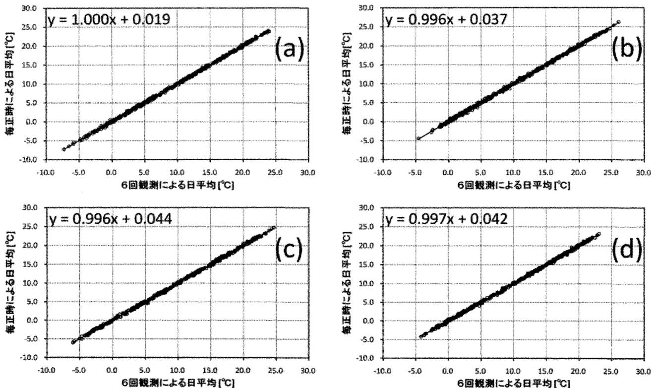
第5図 6回観測による日平均気温（横軸）と毎時値による日平均気温（縦軸）の関係。図中の式は回帰直線を示す。(a) 2006年, (b) 2007年, (c) 2008年, (d) 2009年。
