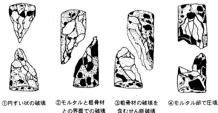
図-3 圧縮強度試験後の供試体の破壊形状
