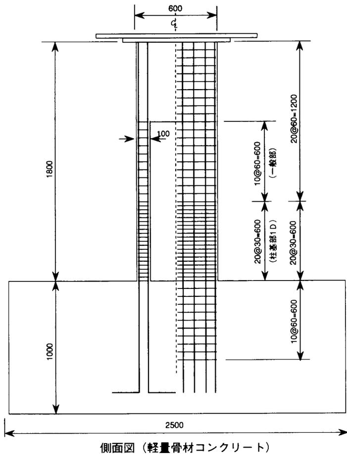
側面図 (軽量骨材コンクリート)
