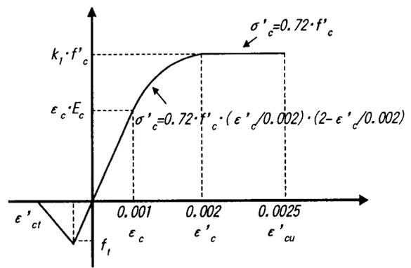
図-1 コンクリートの応力-ひずみ曲線
