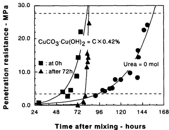
図-8 ユリアがコンクリートの凝結に及ぼす影響
