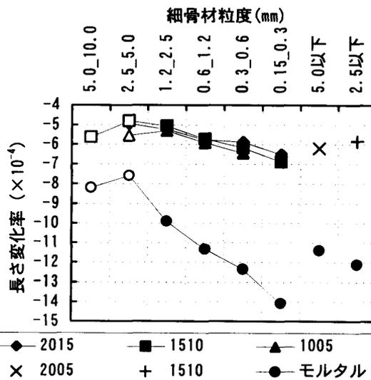
図-12 細骨材粒度と乾燥収縮
