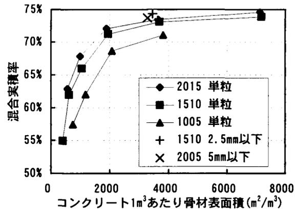
図-4 混合実積率と骨材表面積の関係
