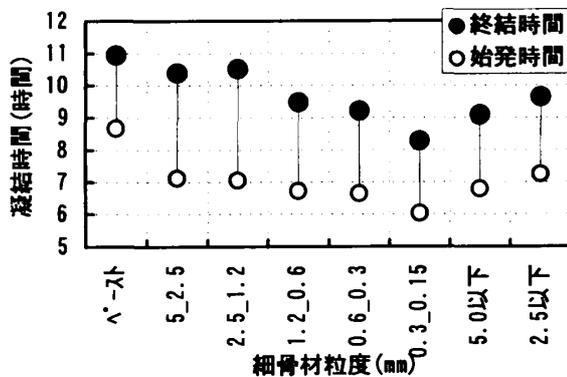
図-9 細骨材粒度と凝結時間の関係
