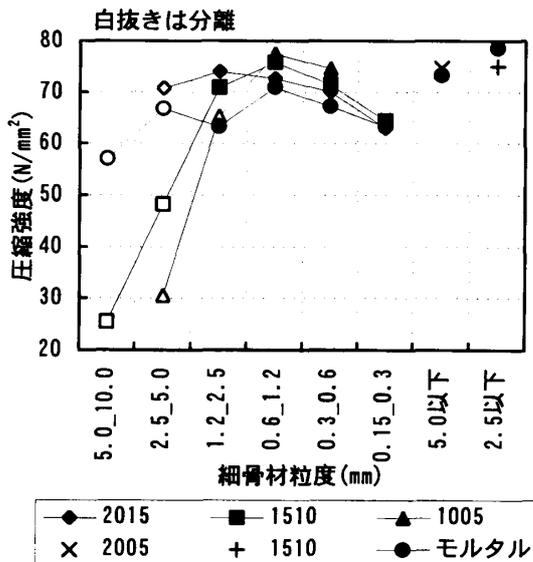
図-10 細骨材粒度と圧縮強度の関係
