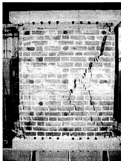
図-22 せん断卓越型崩壊(B2)
