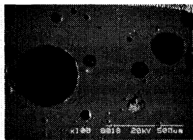
写真-3 溶融炉スラグの反射電子像 (スラグ K)
