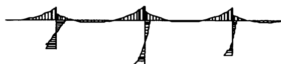
図-6 P1→P3方向入力時 曲げモーメント分布
