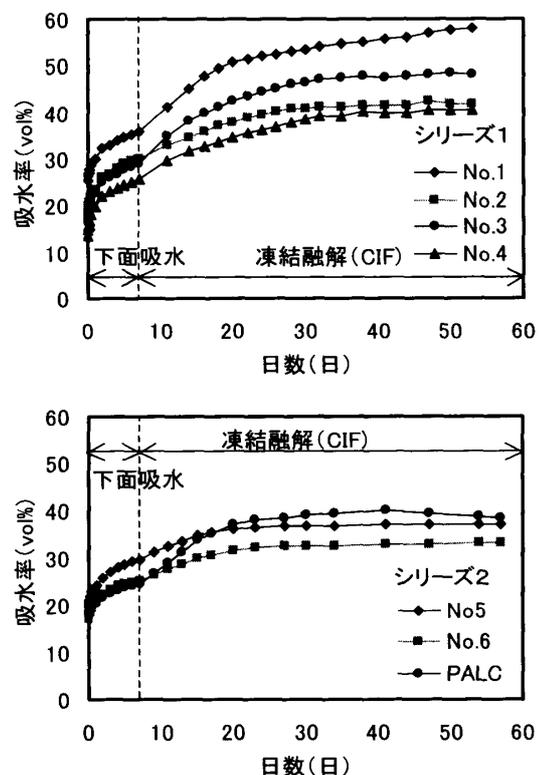
図-8 CIF 試験における吸水率の変化
