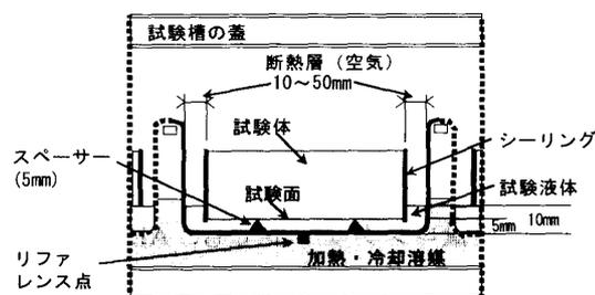
図-1 CIF 試験槽内の試験体と試験容器
