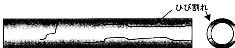
図-1 ひび割れ発生状況イメージ図
