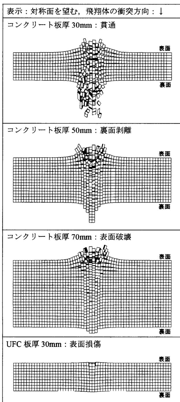
図-12 板の破壊状況 ( $T=250 \mu s$ )
