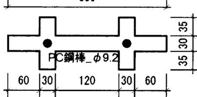
図-3 モデル断面寸法
