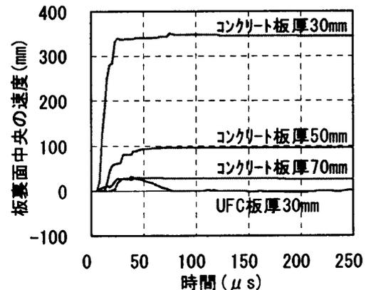
図-11 板裏面中央の速度履歴
