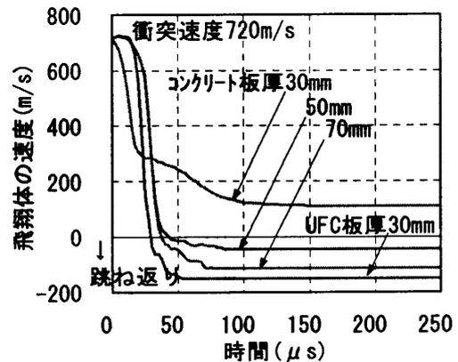
図-10 飛翔体の速度履歴
