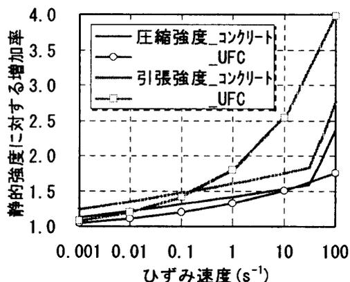
図-1 強度の増加とひずみ速度
