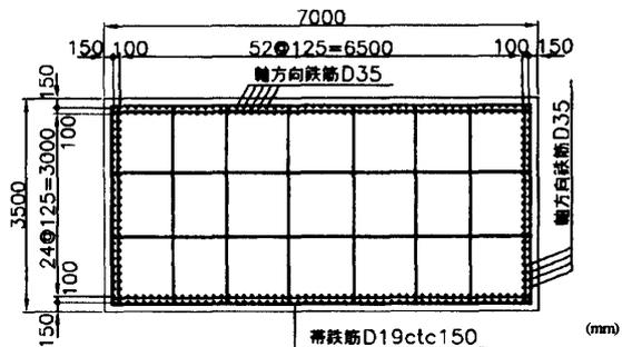
図-3 橋脚配筋図
