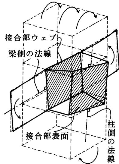
図-8 接合部パネルのねじれ変形
