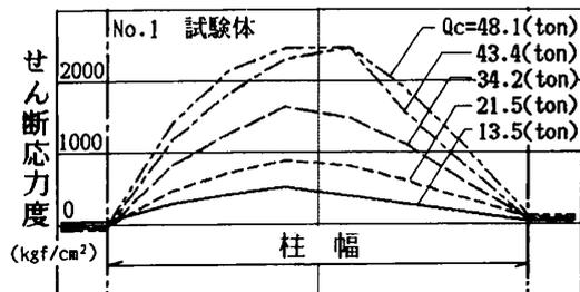
図-4 接合部ウェブのせん断応力
