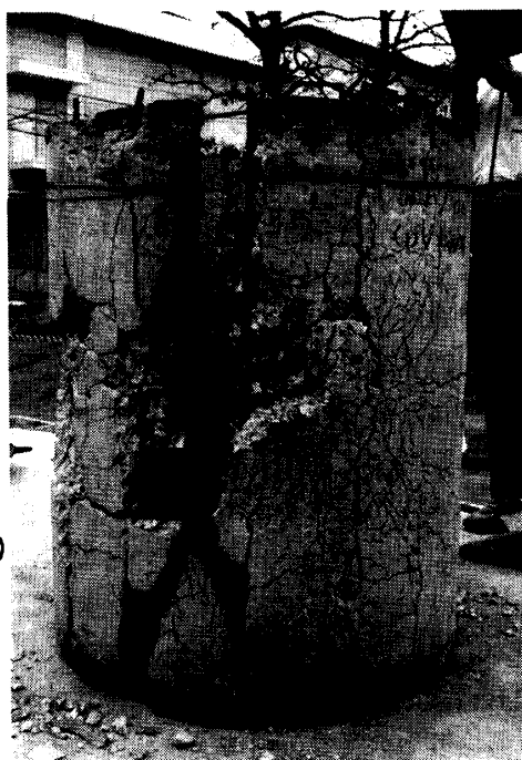
写真1 鉄筋コンクリート円筒体爆発実験における破壊の例(A-1)
