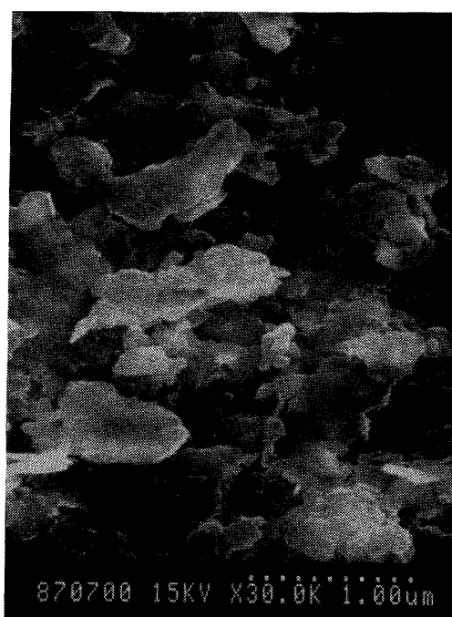
写真-7 骨材Qの潜晶質石英部分の走査 電子顕微鏡写真(3万倍)
