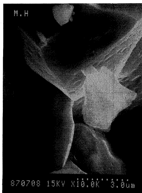
写真-6 骨材Vの潜晶質石英部分の走査 電子顕微鏡写真(1万倍)
