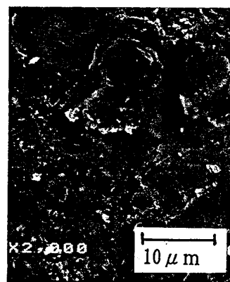
高炉セメントB種 (標準養生供試体)
