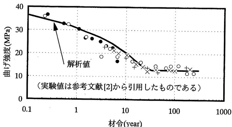
図-7 標準温度20°Cに換算されたGRCの曲げ強度変化
