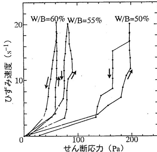
図9 セピオライト混入ペーストのコンシステンシー曲線
