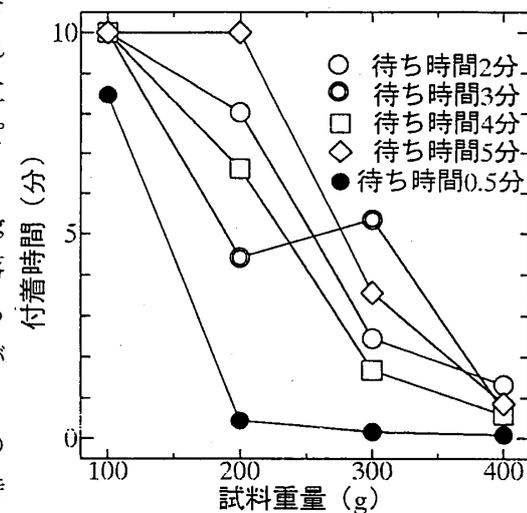
図3 試料重量と付着時間の関係 (セピオライト混入率 7.5%)
