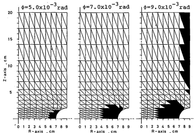
図5(a) 塑性域の進展の模式図(ねじり)
