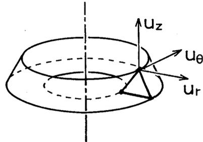
図1 3角形リング要素と節点変位の模式図
