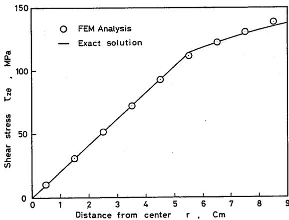
図2 丸棒のねじりにおける厳密解と有限要素法による解の比較
