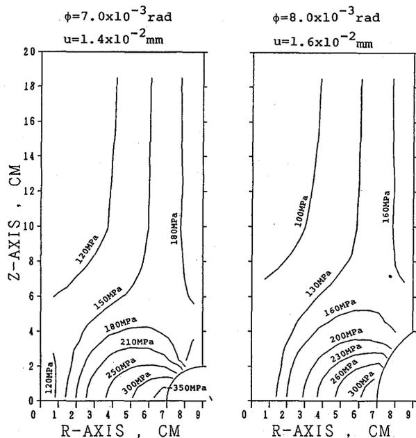
図4(c)  $\bar{\sigma}$  の等高線図 (組合せ)
