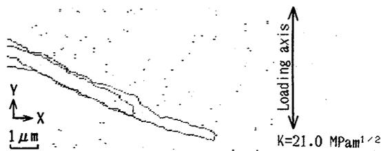
図5 き裂進展量計測例(例1)
