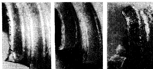
図3. 引張試験絞り部のめっきの剥離
