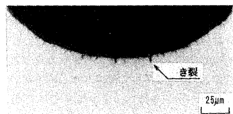
図5 10回の繰返し塑性締めにより発生したねじ底のき裂 (ねじ伸びボルト)
