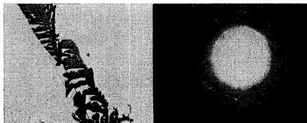
写真2 Crを13%含むMCFの粒界析出物の電子顕微鏡組織( \times 5000 ) (左), と粒界析出物の電子線回折リング (右)
