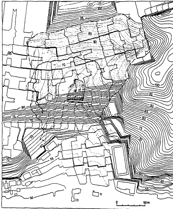
第7図 寿山の地形 鎖線は埋土の範囲，その中の点線は旧谷底の等高線，実線は造成後の等高線，太実線は地震による崩壊部分。（東北大学地質学古生物学教室，1979による）
