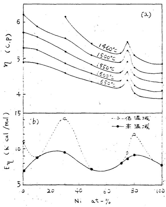
Fig. 3 Fe-Ni 合金の粘性 (a) と粘性流動の活性化エネルギー (b)
