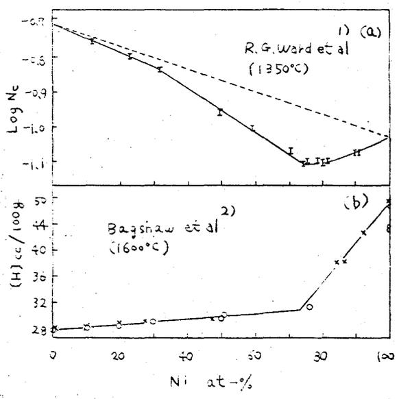
Fig. 4 Fe-Ni 合金の酸素、水素溶解度
