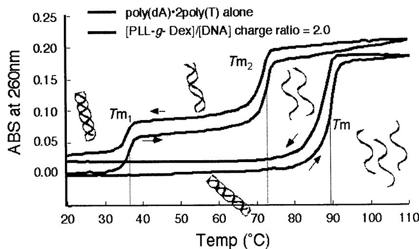
共重合体は既に形成されている2重鎖や3重鎖を安定化することがわかったが<sup>2,3</sup>、一方でDNAと共に重合体間の相互作用がハイブリッドの形成を妨げることが懸念される。図2には、降温測定による2重鎖および3重鎖の形成過程も記されているが、共重合体存在下でも、不在下同様に可逆的なハイブリッド形成が観察される。ハイブリッド形成過程に及ぼす共重合体の効果を、表面プラスモンセンサーを用いてさらに定量的に評価した。ここでは、3重鎖形成の速度論的解析を行った結果を図3に示
