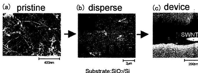
図 2 試料作成の例。(a) レーザー法で作製した単層カーボンナノチューブの電子顕微鏡写真。(b) ジクロロエタン中で超音波を用いて分離させて SiO<sub>2</sub> 上に分散させた様子。(c) 電子ビーム露光と蒸着によってカーボンナノチューブに金属電極を作製。
