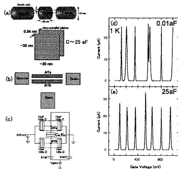
図12 多層カーボンナノチューブにおける静電容量結合の単電子効果に対する影響。(a)2層ナノチューブにおいてトンネル接合を介したアイランド構造を想定。アイランド長を30 nmとした場合、2層チューブの静電容量は25 aFとなる。(b)2層のチューブがそれぞれソースとドレインにトンネル接合するとする。(c)この構造を書き下した等価回路。等価回路を用いて1 Kにおいて計算した単電子効果のゲート電圧変化による回路を流れる電流。静電容量0.01 aF(d)と25 aF(e)の伝導特性。
