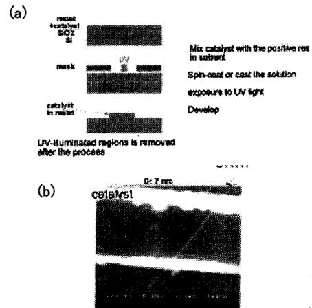
図 13 CVD 法によるナノチューブ成長制御の試み。アルミナ混入 Fe-Mo 触媒をヘキスト UV レジストに混ぜ SiO<sub>2</sub>/Si 基板上に塗布し 900°C にて CH<sub>4</sub> 反応を行った。(a) プロセス概略図。(b) 反応によって得た SWNT の SEM 写真。
