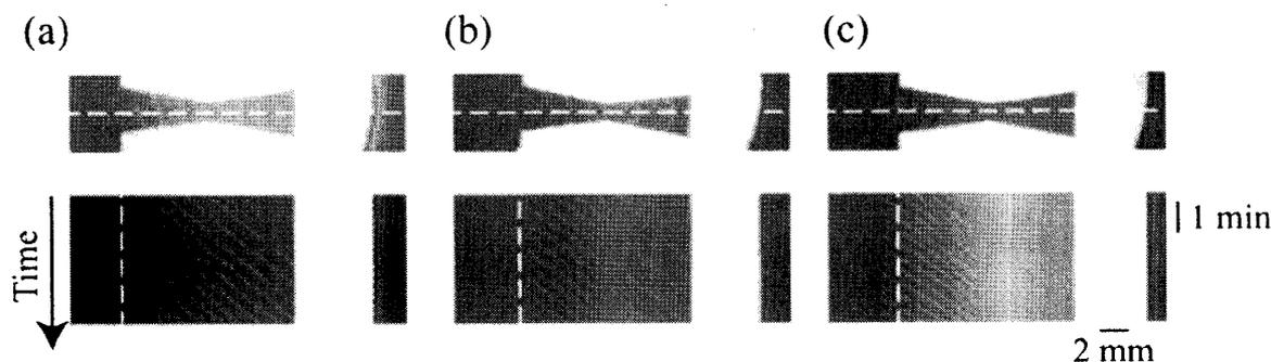
図 2: くびれのある形状の反応場に化学波を伝播させた時。それぞれスナップショット (上) と、スナップショット内の点線を時間的につなぎ合わせて作った時空間プロット (下) を示す。(a) 反応性が高い時。すべての化学波がくびれた部分を通り抜けて伝播していく。(b)(a) よりもやや反応性を下げた時。一つおきに化学波が消滅し、くびれを通った後、波長が 2 倍になる。(c) 反応性が低い時。すべての化学波はくびれを通る前に消滅する。
