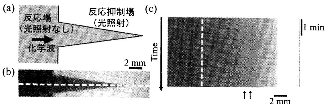
図 1: 三角形の形状の反応場での実験。(a) 実験の模式図。光を照射して作った反応場上で化学波を左から右へと伝播させその挙動を見る。(b) 化学波のスナップショット。(c) スナップショット (b) の点線部をつなぎ合わせて作った時空間プロット。化学波の伝播が止まる位置が一つおきに異なる (二つの↑で示す)。
