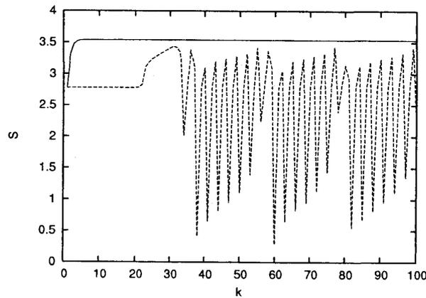
図 2: 二つの逐次近似法による SGR モデルの解析. パラメーターは  $\varepsilon = 10^{-5}$ ,  $U = -1$  とした. このグラフは横軸が逐次計算の回数, 縦軸がエントロピーを表している. 実線は新しい方法での結果で, エントロピーは単調に増加し 10 回前後で収束する. 一方, 破線は従来の方法によるもので, エントロピーは振動し続けて 100 回の計算でも収束しない.
