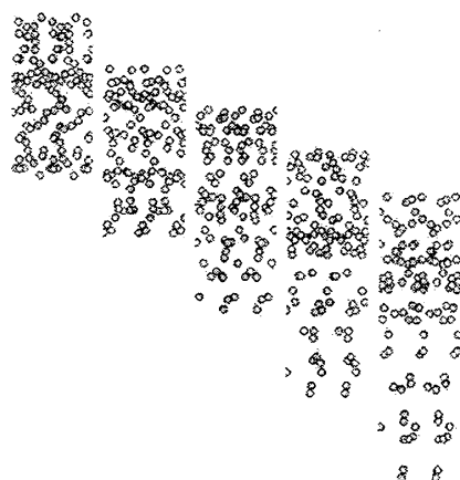
図 5: ランダム配置を有する有限粒子層の拡散挙動 (絶対座標系). 初期層高および初期体積濃度は図 4 で示した規則粒子層の場合と同じ L_0/a = 40 , \phi_0 = 0.064 とした.
