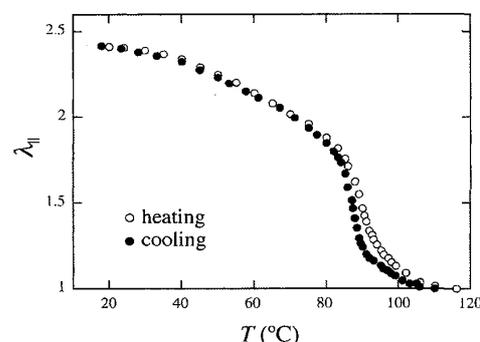
図2. モノドメイン LCE の熱変形挙動[5].  $\lambda_{||}$ はダイレクター方向の軸比
