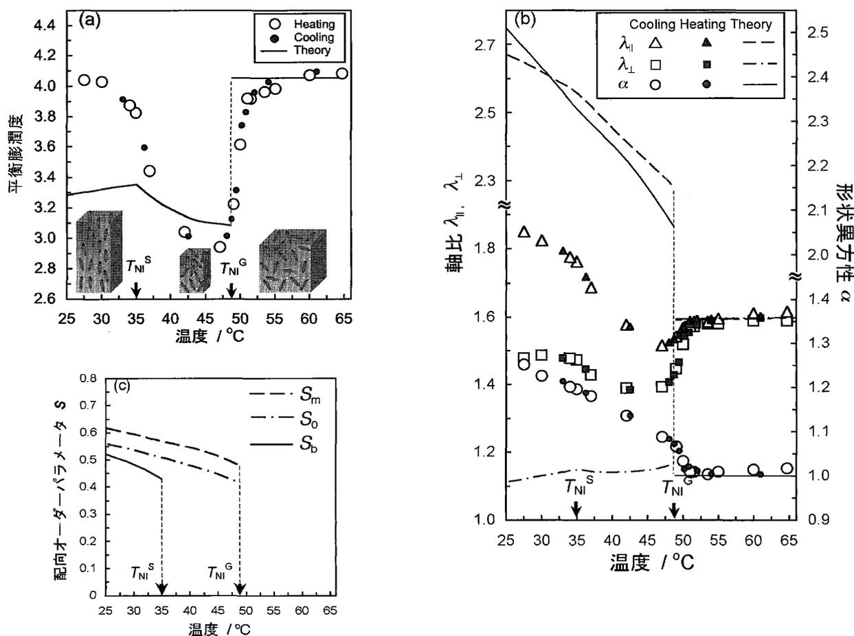
図5. モノドメインLCE/液晶溶媒系の体積相転移挙動[19]。  $\alpha = \lambda_{\parallel}/\lambda_{\perp}$
