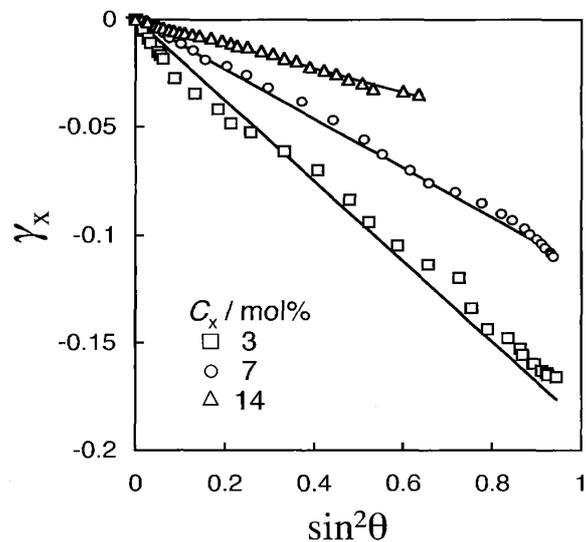
図8. 架橋濃度( $C_x$ )の異なる液晶ゲルのひずみとダイレクターの回転角の関係[30]
