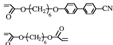
図 3. LCE 作製に用いる化合物の一例
