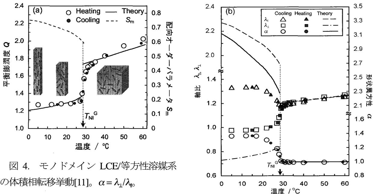
図 4. モノドメイン LCE/等方性溶媒系の体積相転移挙動[11]。  $\alpha = \lambda_1/\lambda_0$
