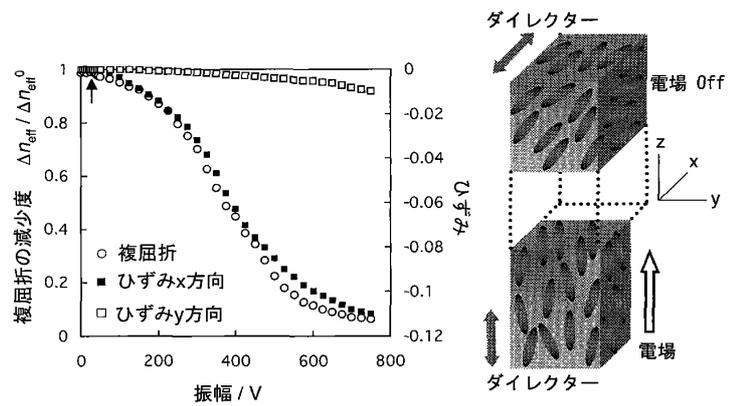
図7. 液晶ゲルの電気光学力学効果[29]
