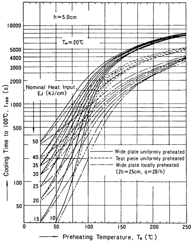
Fig. 14(e) Cooling time to 100°C ( $h=5.0$  cm)
