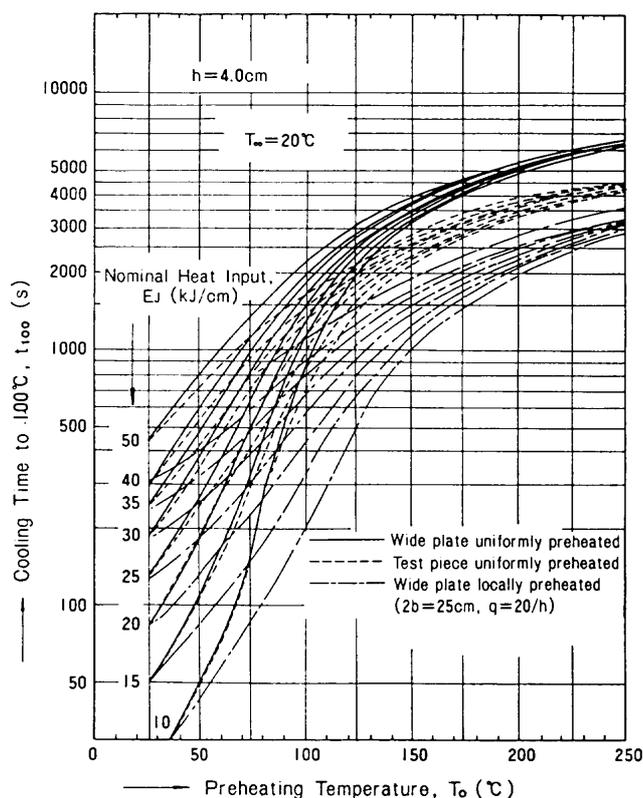
Fig. 14(d) Cooling time to 100°C ( $h=4.0$  cm)
