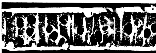
a 単板 a—veneer 裏割れ率 Percentage of lathe check 10~25% 面粗さ (凸部) Roughness 平均値 ave. 0.037mm 最大値 max. 0.090mm 試料採取位置 Sampling position 35回転目 The 35th rotation
