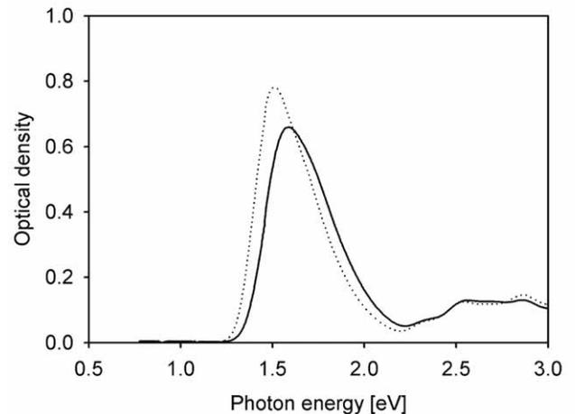
図 5 アルキルオキシ基を持たない EO 色素 (試料 (b)) (実線) と持つ EO 色素 (試料 (c)) (点線) の吸収スペクトル
