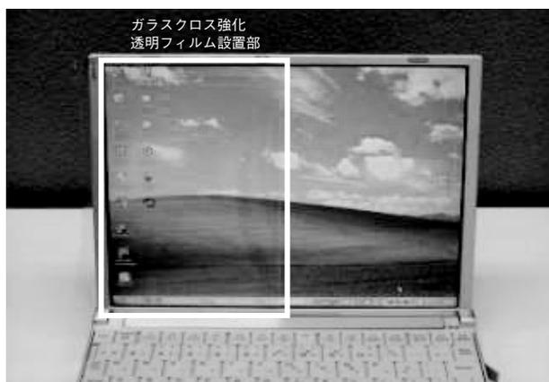
図5 ガラスクロス強化透明フィルムの外観
