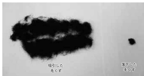
図11 吸引および落下した毛くずの例
