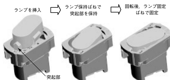
図17 新ソケットの操作方式
