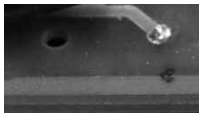
図7 雷サージ試験での放電痕
