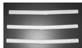
写真7 曲げ試験結果
