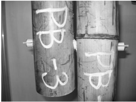
写真4c 軸平行試験体破壊形状 (PB3)
