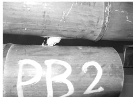
写真4b 軸平行試験体破壊形状 (PB2)
