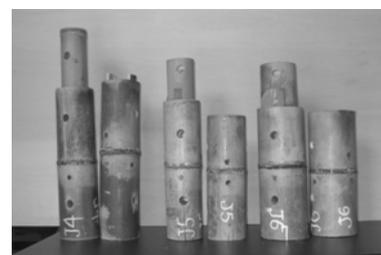
写真12 竹材継ぎ手2試験体破壊形状一覧
