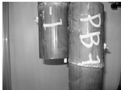
写真4a 軸平行試験体破壊形状 (PB1)
