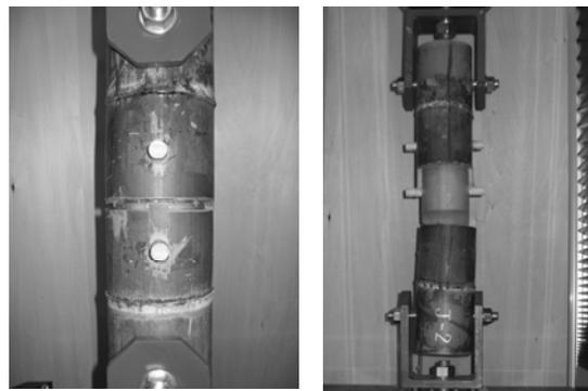
写真10 竹材継ぎ手1破断状況 (両者とも J2 試験体)
