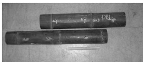
写真2 軸直交試験体破壊形状 (DB1)
