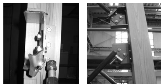
図 10a _1 PB2 破壊状況 図 10b _1 PB3 破壊状況
