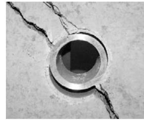
写真-3 試験体 C-V-R 最大耐力時
