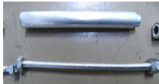
写真 5 M10-1P 試験体 (上) ブレース座屈変形図 (下)
