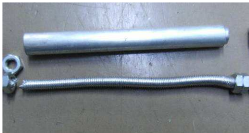
写真 4 M8-1P 試験体 (上) ブレース座屈変形図 (下)
